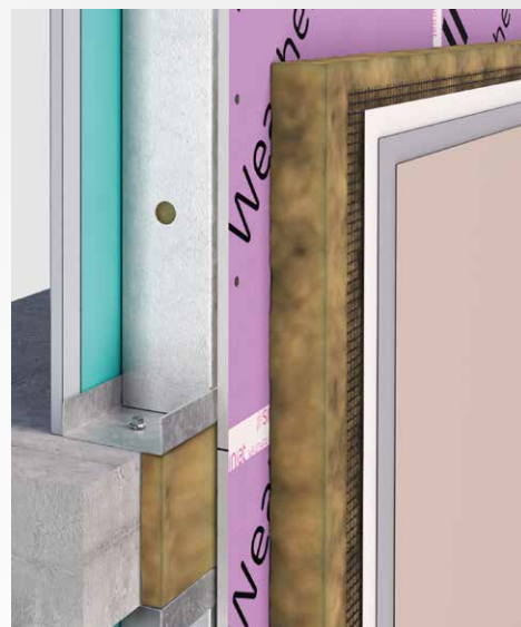
Eingestellte Fassade Inserted facade / Infill Wall Façade indépendante
