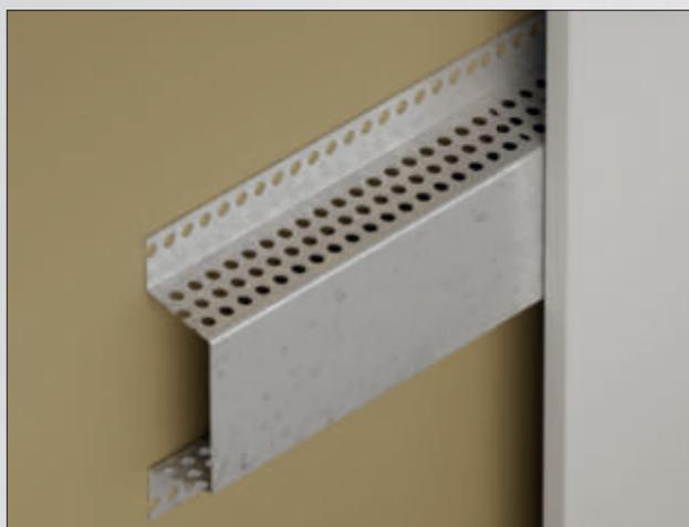
Das PROTEKTOR Omega-Lüftungsprofil (Art.-Nr. 9363) ist ein Hutprofil aus Aluminium mit Lüftungslöchern. Die Höhe des Profils beträgt 30 mm; der Boden ist 60 mm breit. Entlang des Profils sind Lüftungslöcher mit einem Durchmesser von 5 mm angebracht. Der freie Lüftungsquerschnitt am Schenkel 30 mm beträgt 75 cm<sup>2</sup>/lfm. Die Materialdicke beträgt 1 mm. Das Protektor Omega-Lüftungsprofil ist vielseitig verwendbar.
