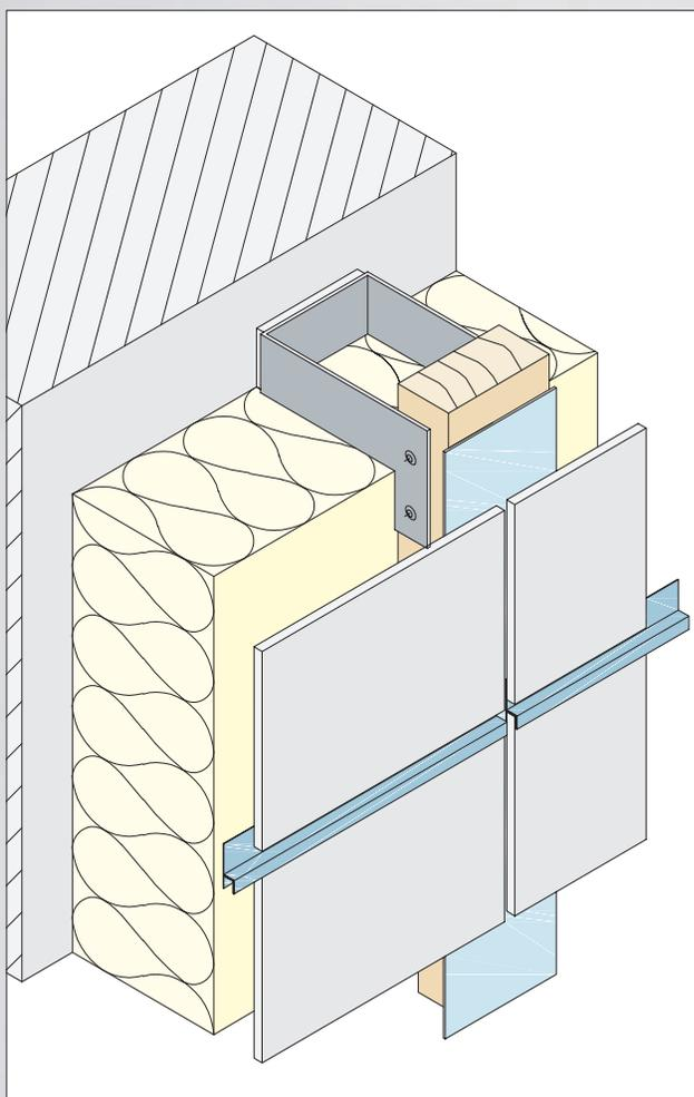
Die Fugenprofile bzw. h-Profile aus Aluminium und PVC finden Ihre Anwendung bei der horizontalen Fuge. Sie reduzieren das Eindringen von Feuchtigkeit. Bitte achten Sie darauf, dass die Platten nicht auf das Profil direkt aufgesetzt werden, sondern eine Fuge von ca. 5 bis 10 mm bzw. nach Angabe des Plattenherstellers gelassen wird.
