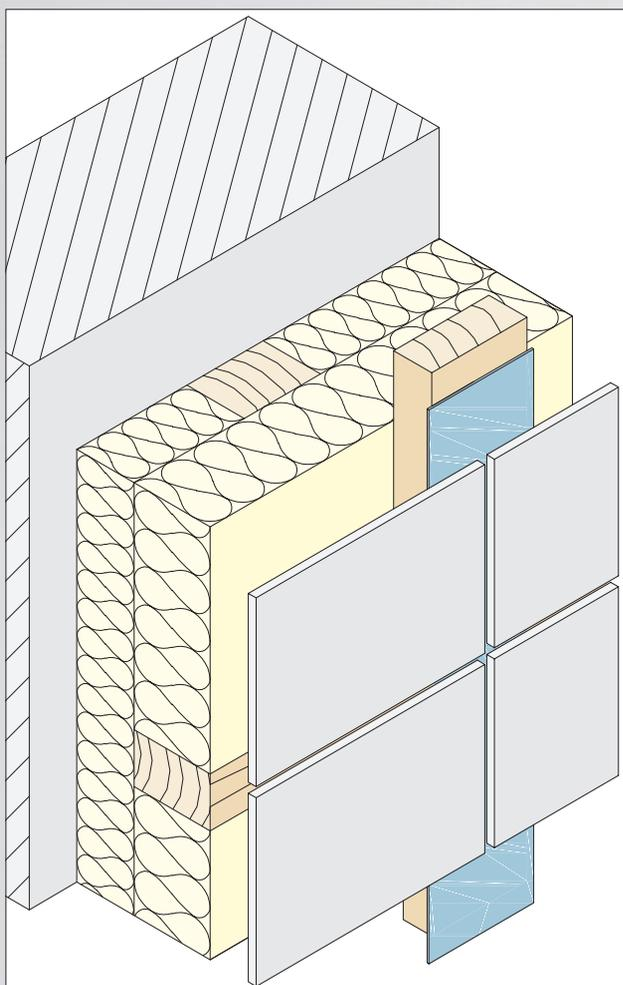
Die Fugenbänder kommen bei der vorgehängten hinterlüfteten Fassade zum Einsatz und haben verschiedene Funktionen.
