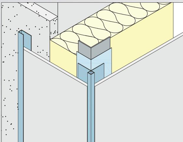
Der Anschluss einer vorgehängten Fassade über Ecke zu einer anderen Fläche, beispielsweise einer verputzten Fläche oder WDVS, kann einfach mit einem Kantenprofil und einem U-Einfassprofil ausgeführt werden. Beispielsweise hier mit Kantenprofil Nr 9440 und U-Einfassprofil Nr 9450. Protektor bietet hierbei eine große Auswahl an Fassadenprofilen.
