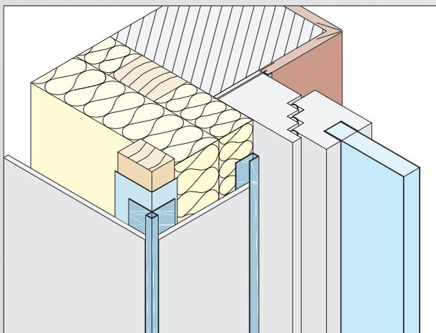
Mit den Abschluss- und Einfassprofilen bzw. U-Profilen können Fassadenplatten ideal an verschiedenen Positionen wie z. B. an Fenster- und Türleibungen befestigt werden.
