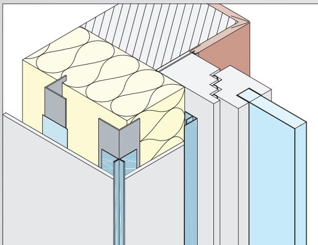
Die Laibungsausbildung kann auf unterschiedliche Arten ausgeführt werden. In der Praxis wird je nach Wunsch des Bauherrn u. a. die Fassadenbekleidung in der Laibung fortgesetzt oder auf bestehende Systeme zurückgegriffen.
