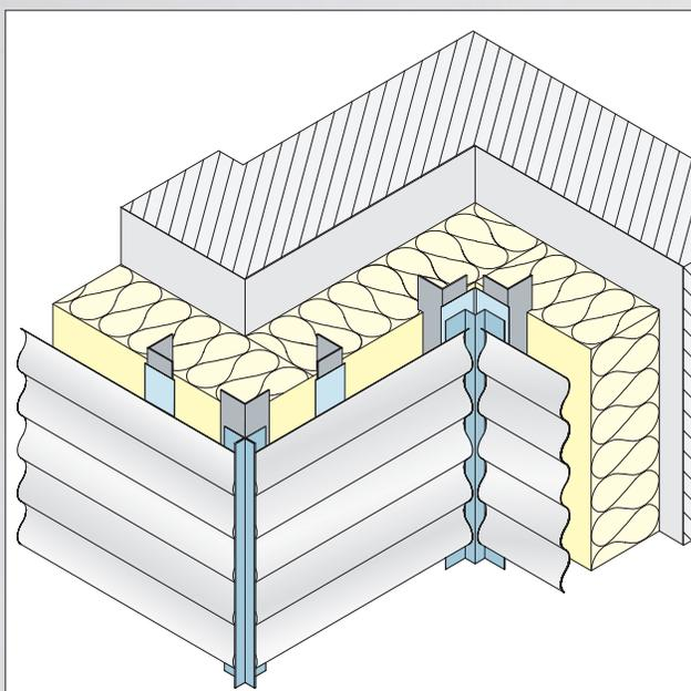
Kantenprofile für Innenecken bilden einen sauberen Abschluss der Fassadenbekleidung.
