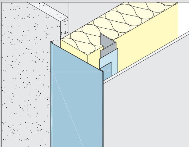
Die Anschlussprofile schließen die Fassadenbekleidung an anderen Flächen der Fassade wie z. B. Putz an und ermöglichen einen einfachen und sauberen Übergang. Sie bedecken die Schnittkanten der Fassadentafeln, bilden einen sauberen Anschluss und decken seitlich die Unterkonstruktion ab.
