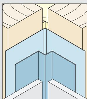
Kantenprofile dienen der Fassadengestaltung. Sie bedecken die Schnittkanten der Fassadentafeln und bilden eine saubere Kante.
