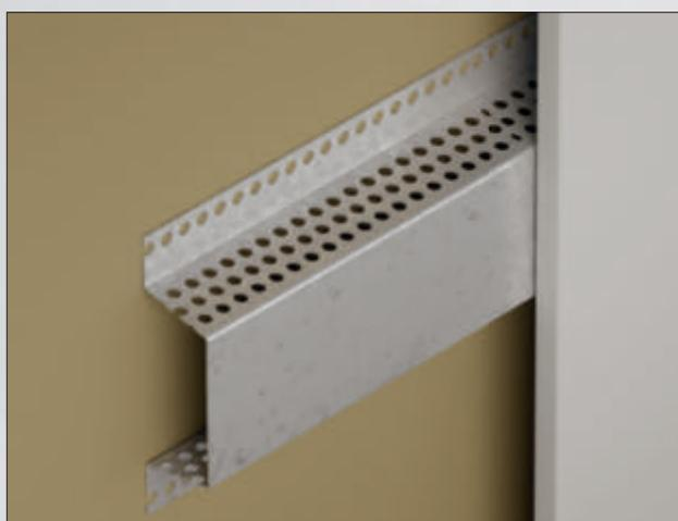
Le profilé d'aération PROTEKTOR Omega (Art.-Nr. 9363) est un profilé chapeau en aluminium avec des trous d'aération. La hauteur du profilé est de 30 mm ; la largeur du fond est de 60 mm. Le long du profilé se trouvent des trous d'aération d'un diamètre de 5 mm. La section d'aération libre au niveau de l'aile de 30 mm est de 75 cm<sup>2</sup>/mètre linéaire. L'épaisseur du matériau est de 1 mm. Le profilé d'aération Protektor Omega peut être utilisé de manière polyvalente.
