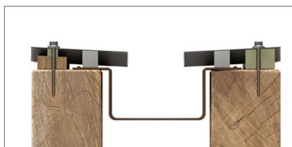
Le décalage/l'entretoise permet d'éviter tout effet de coincement dû à la couverture et permet à la gouttière du carport de se déplacer thermiquement indépendamment de la construction du toit. La pente de la gouttière Carport peut être comprise entre 0 et 3 mm/m.
